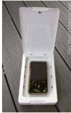
Ein vollständiger Desinfektionszyklus im „UV-Sanitizer“ dauert etwa 5 min und tötet bis zu 99,99 % der häufigsten Oberflächenbakterien ab.
