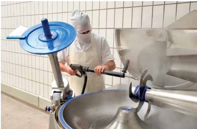
Der über drei Meter lange Schlauch und die verschiedenen Aufsätze ermöglichen die Reinigung selbst schwer zugänglicher Stellen
