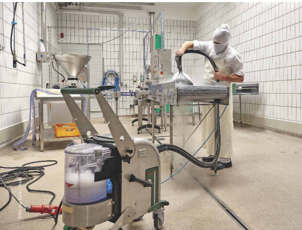
Die Trüffelmanufaktur Göschle aus Offingen setzt für die zuverlässige und umweltschonende Reinigung ihrer Produktionshalle das Dampfsaugsystem Blue Evolution XL+ von Beam ein
