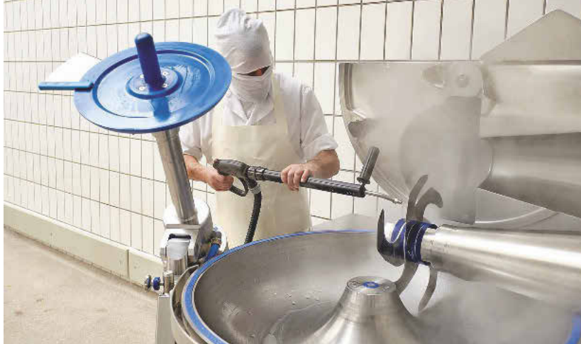
Mit dem Dampfsaugsystem Blue Evolution XL+ lassen sich große Flächen ebenso wie schwer zugängliche Stellen optimal reinigen. Möglich machen das der über 3 m lange Schlauch und die verschiedenen Aufsätze.
