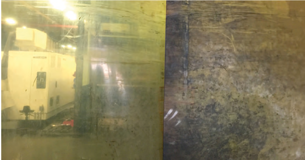
Der Vorher-Nachher-Effekt: Links die gereinigte Fläche der PVC-Pendeltür, rechts die ungereinigte Fläche. (Foto: Beam GmbH)
