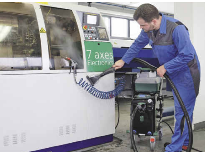
Die Dampfsaugsysteme kommen ohne Reinigungsmittel aus und sorgen für Sauberkeit und Sicherheit im betrieblichen Umfeld. Bild: Beam
