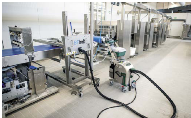
■ Abb. 3: Mit dem Bandreinigungssystem Bebelt spart die Bio-Bäckerei Moin bis zu eineinhalb Stunden Reinigungszeit täglich. Die Innovation arbeitet chemiefrei und wird an das Dampfsaugsystem Blue Evolution XL+ angeschlossen.
