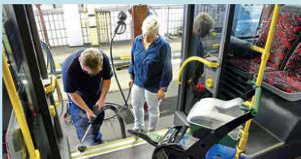
Grundreinigung mit dem Dampfsaugsystem BlueEvolution S von Beam. Hier die Reinigung der Einstiegsprofile.
