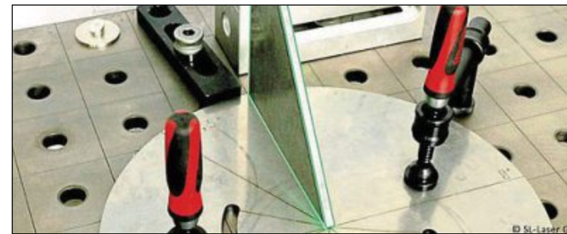
Mit Laserlicht Werkstücke exakt positionieren. FOTO: SL-LASER GMBH
