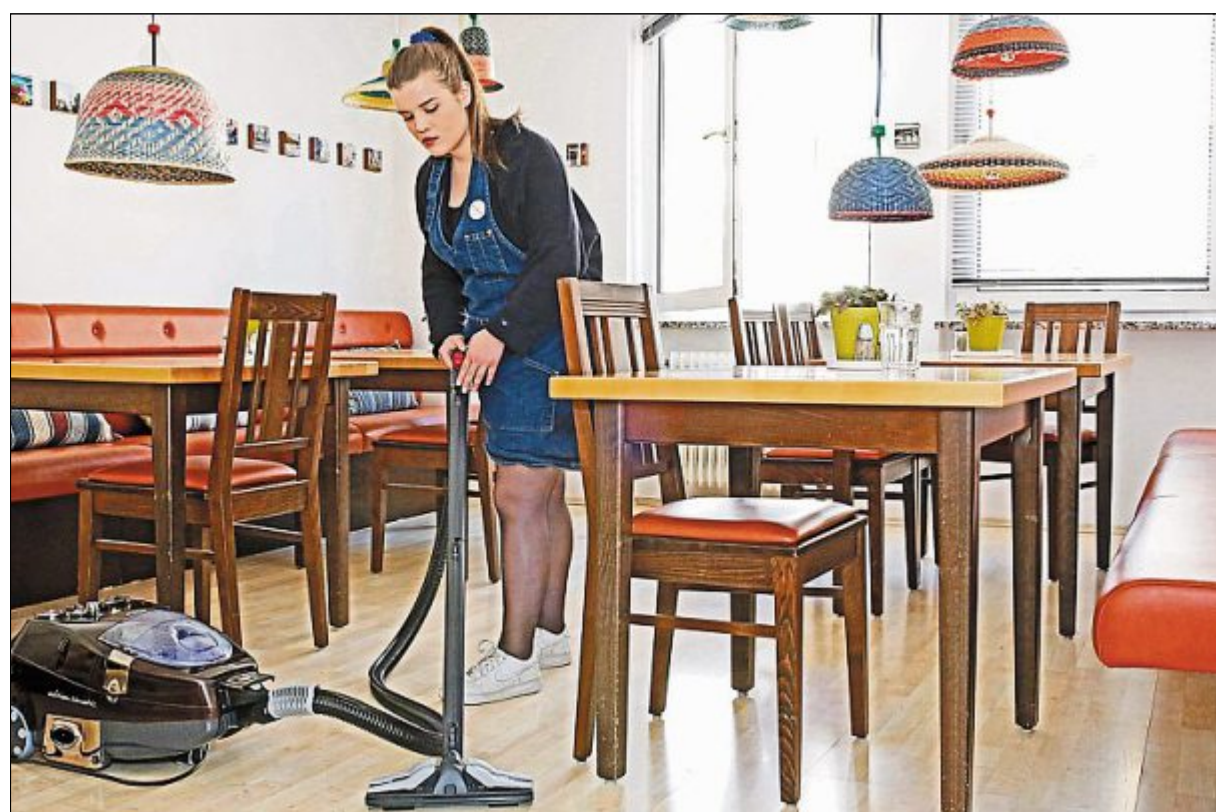
Das Dampfsaugsystem sorgt im Frühstücksraum des Müller Inn für Sauberkeit. Das Gerät dampft mit einer Temperatur von maximal 150 Grad Celsius und einem Druck von 4,5 bar. Innerhalb von drei Minuten ist es aufgeheizt und somit in kürzester Zeit betriebsbereit. FOTO: SABRINA DEININGER/BEAM GMBH
