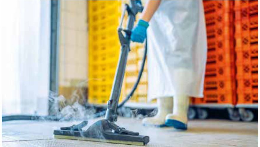
Der Dampfdruck der Multifunktionsgeräte, die über verschiedene Aufsatzdüsen verfügen, lässt sich so regulieren, dass alle Oberflächen gründlich und schonend gesäubert werden können. Adrian Müller/beam
