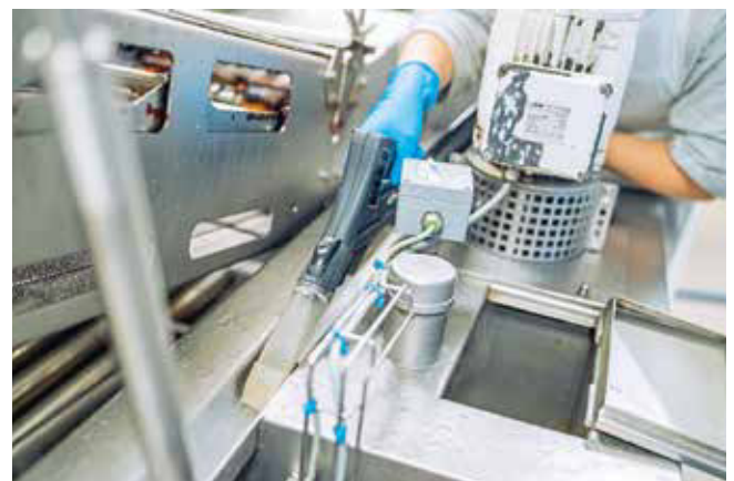
Bei jeder Zwischenreinigung befreit der Blue Evolution XL+ die Förderflächen von Produktresten, sodass die nächste Beilagencharge direkt produziert werden kann. Adrian Müller/beam
