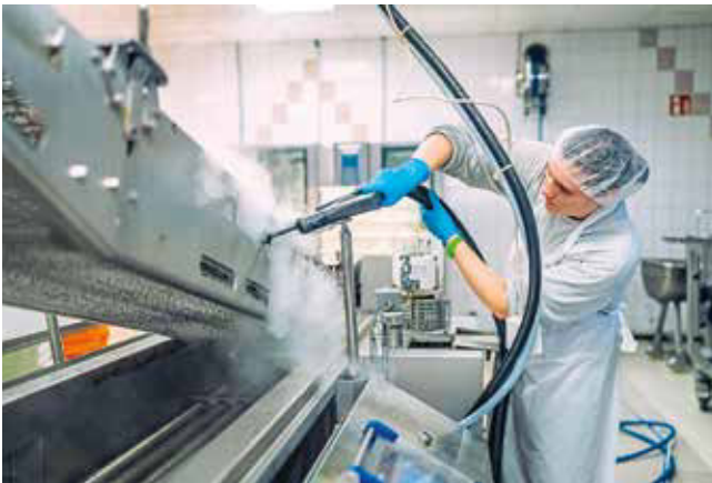
Mit dem Rundbürstenaufsatz an der Punktstrahldüse des Blue Evolution XL+ werden die Arbeitsoberflächen blank gedampft.
