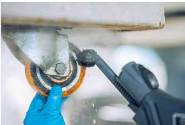
Mit dem Dampfsaugsystem können die Räder der Produktionstische in nur je 30 Sekunden gereinigt werden – deutlich schneller als zuvor. Adrian Müller/beam
