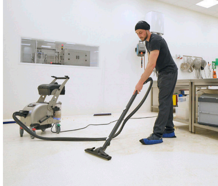
Das UVC-Licht im Wassertank beseitigt zusätzlich Viren und Bakterien aus der Raumluft. Rechts: Durch die hohe Wendigkeit lässt sich der Dampfsauger auch bei engen Platzverhältnissen nicht ausbremsen.
