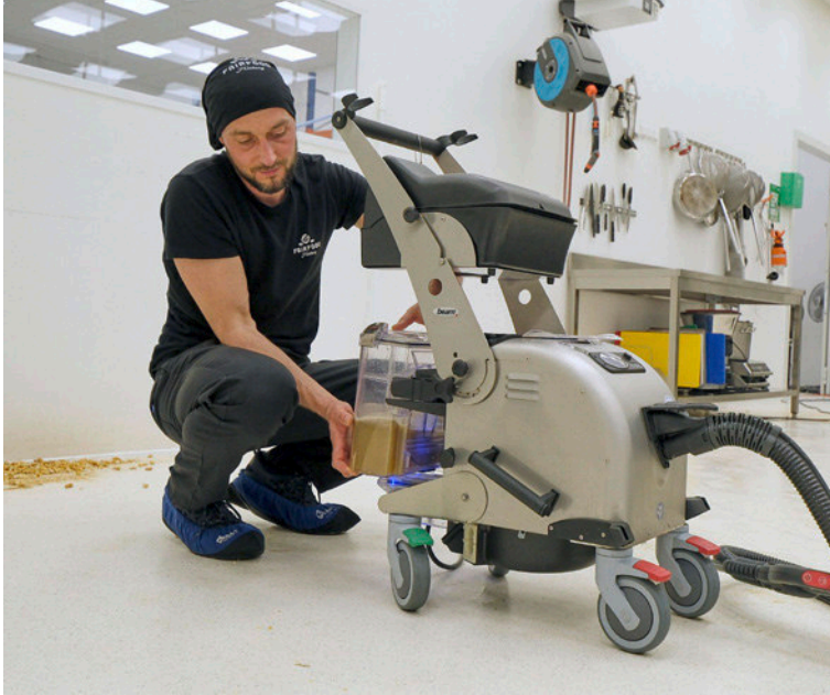
Das UVC-Licht im Wassertank beseitigt zusätzlich Viren und Bakterien aus der Raumluft. Rechts: Durch die hohe Wendigkeit lässt sich der Dampfsauger auch bei engen Platzverhältnissen nicht ausbremsen.
