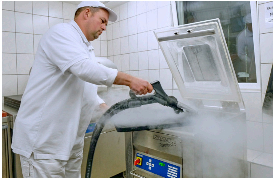
Das Multifunktionsgerät arbeitet mit bis zu 180 Grad Celsius heißem Trockendampf bei minimalem Wassereinsatz.
